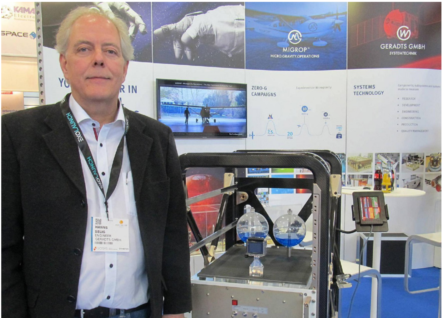
Projektmanager Hanns Selig von der Bremer Geradts GmbH steht neben einer Plattform, mit der an Bord einer Cessna bei Parabelflügen Experimente unter Schwerelosigkeit gemacht werden. Das Unternehmen präsentiert sich auf der Fachmesse „Space Tech Expo Europe“.
